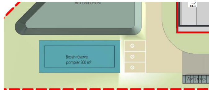
Réserve incendie Angle Sud-ouest
