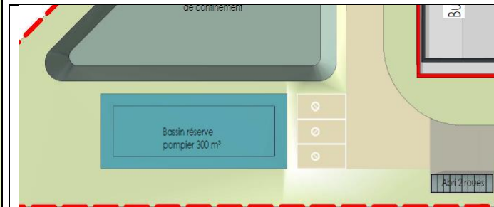
Réserve incendie Angle Sud-ouest
